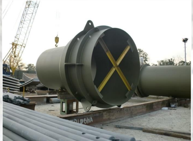
Funnel of LNG Inlet Pipe [9% Nickel steel]
