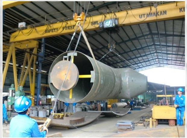
Reducer of LNG Inlet Pipe [9% Nickel steel]
